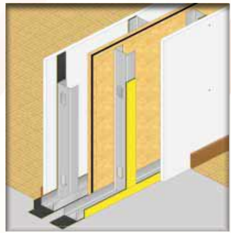
Sistema de doble estructura
