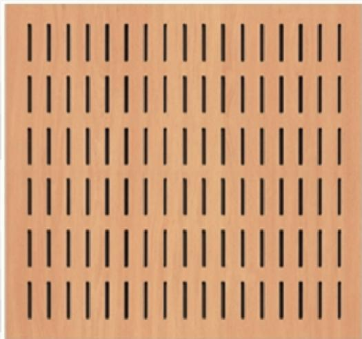
Módulos de 12 mm de espesor con ranuras pasantes de 4/6/8/10 x 61 mm, separadas 32 mm entre ellos.
