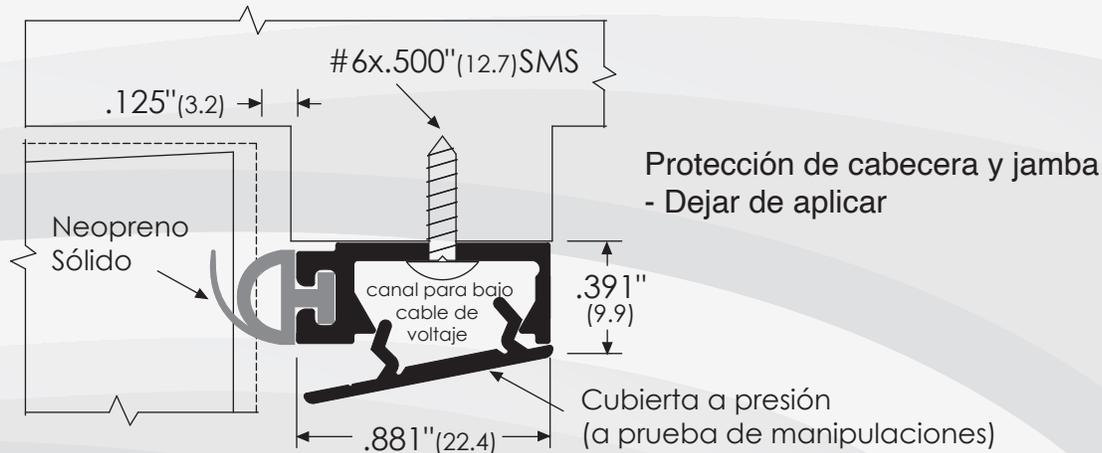
Cubierta a presión (a prueba de manipulaciones)
